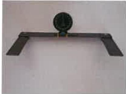
Figure 2 : photo de l'inclinomètre attaché adapté avec 2 branches.
