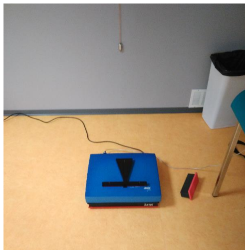
Fig 4 : Plateforme Satel® + mousse Airex®
