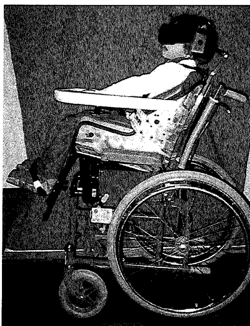
Figure 2 : adaptation du corset-siège au fauteuil roulant
