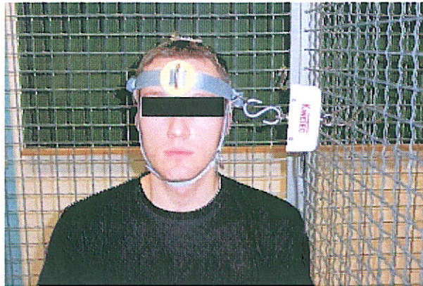
Figure 10 : Installation du dynamomètre électronique
