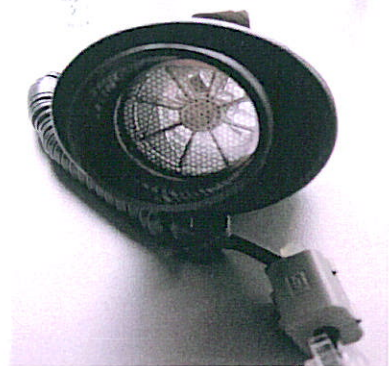
capteur de courant inspiratoire et expiratoire par rotation de l'hélice
