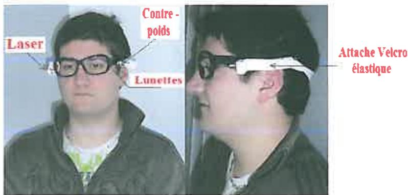
Figure 3 : Système de lunette avec laser intégré
