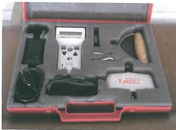
Figure 1 : Dynamomètre Kinétec® utilisé pour la mesure de la RM s
