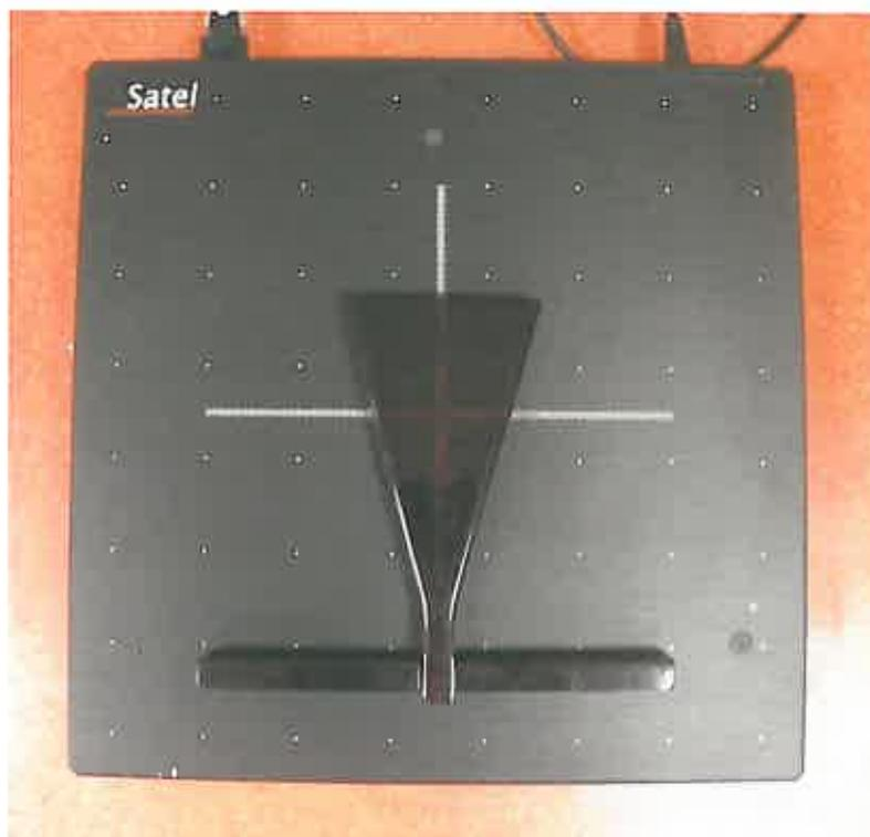
*Figure 3 : plateforme SATEL® avec les cales permettant de placer les pieds de façon normalisé*
