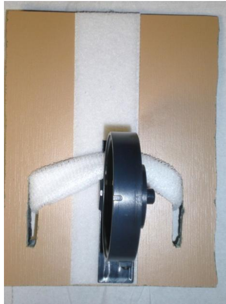
Figure 11 : Face de la tablette fixant l'inclinomètre
