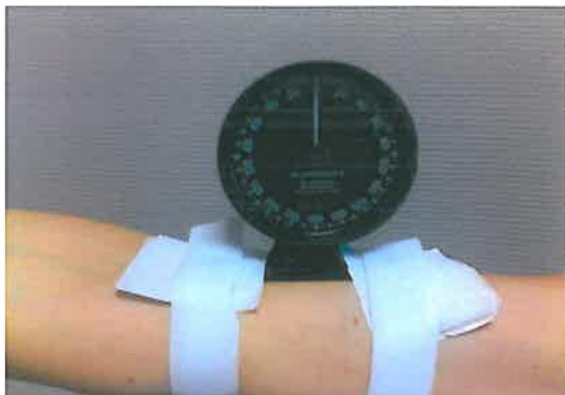
Figure 7 : Position du goniomètre de RIPPSTEIN au tiers inférieur du bras du sujet.
