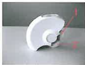
Figure 3 : Spinal Mouse® (1 : roue de roulement ; 2 : roue de guidage)
