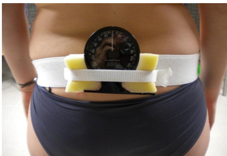
Figure 2: Montage de fixation du 3ème inclinomètre
