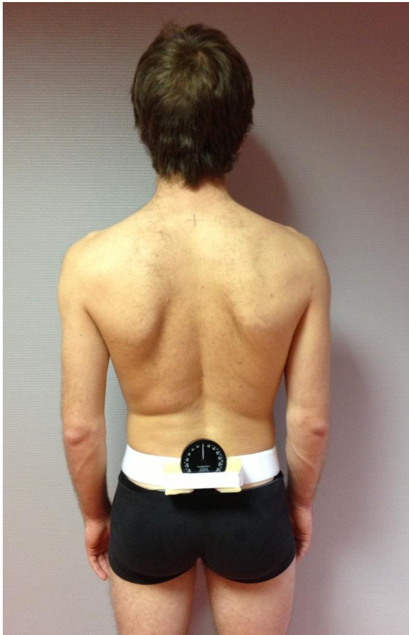
Figure 10: Installation du montage de maintien de l'inclinomètre
