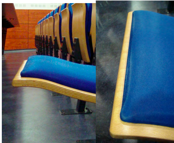
Figure 10 : Photographies montrant l'écrasement de la mousse au bord antérieur de l'assise.
