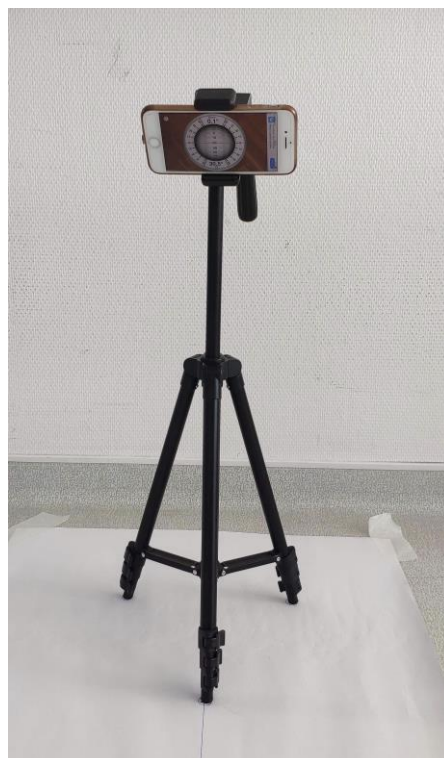
Figure 10 : Placement de la caméra à 30° vers le sol avec l'application rotating sphere clinometer.
