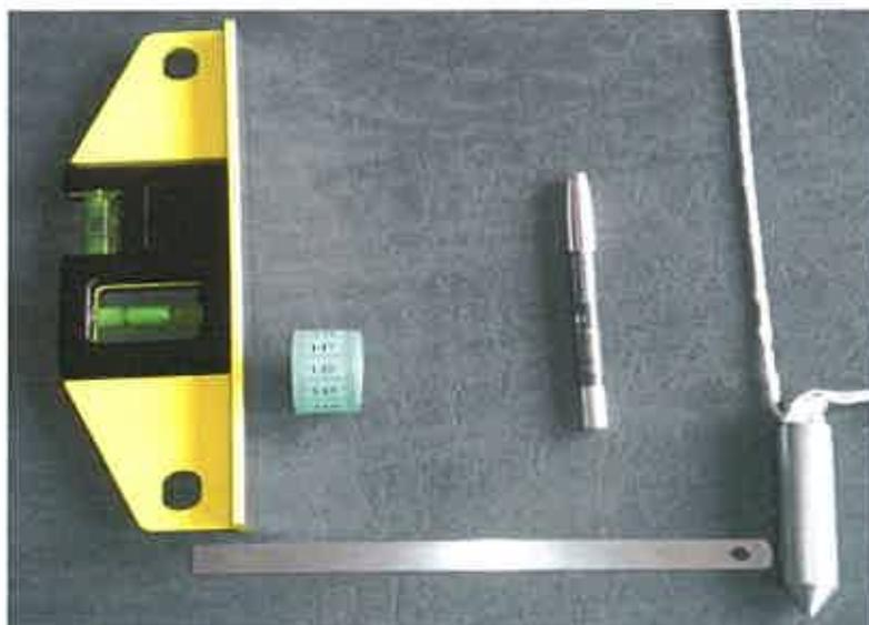
**Figure 4 : matériel nécessaire, niveau à bulle, fil à plomb, mètre ruban, crayon dermographique, règle.**
