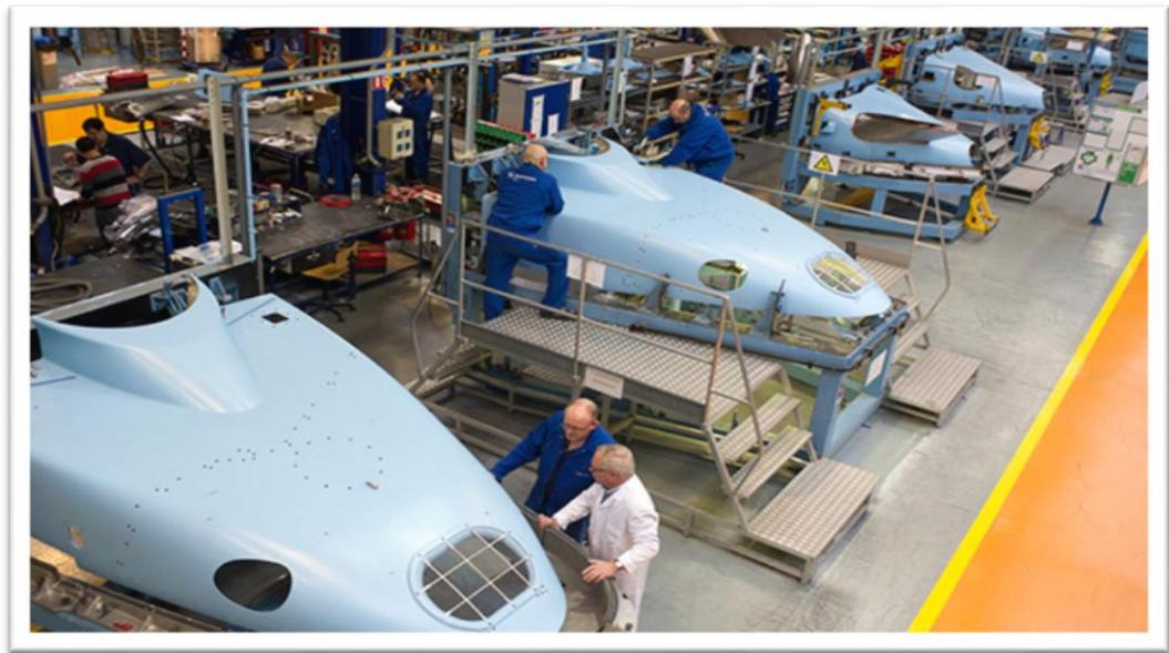
Figure 2 : Capots avant pour Airbus hélicoptères
