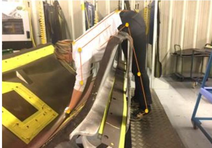
Figure 6 : Analyse angulaire de la posture de drapage la plus fréquente pour ce poste
