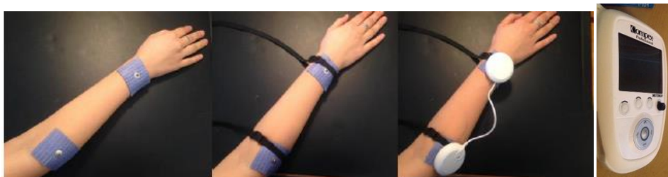
Figure 4 : adaptation pour fixations des électrodes, et adaptation du bouton en relief
