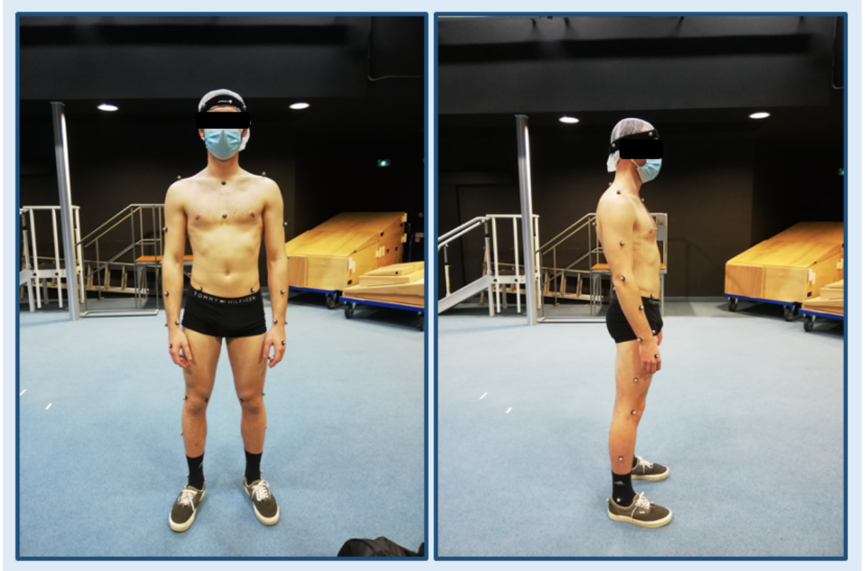
Figure 2 : Photographies de l'installation des marqueurs réfléchissants selon le modèle Plug-In-Gait de ViconTM.
