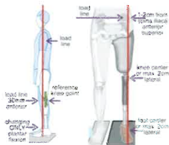
Figure 6 : Alignement adapté de prothèse chez les amputés fémoraux [41] [annexe VI]
