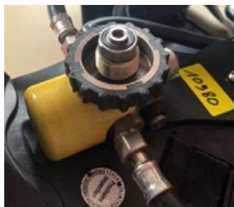
Figure 5 : Photographie du détendeur haute pression de l'ARICO.
