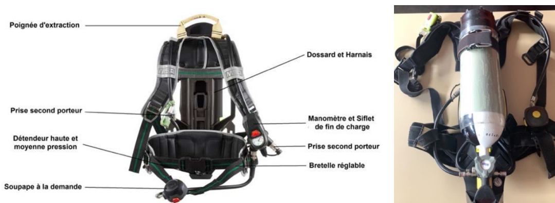
Figure 4 : Photographies annotées du harnais de l'ARICO de dos (Bezier.N(13)) et de face.
