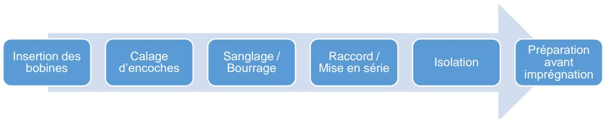
Figure 11 : processus général de la ligne bobinage.
