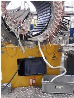
Figure 14 : sanglage avec une corde de fibre de verre.
