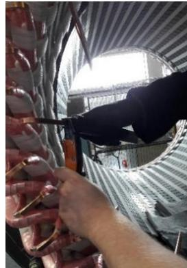
Figure 15 : pliage des connexions.
