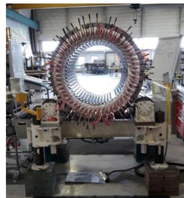
Figure 10 : exemple de stator sur un vireur avec bobines insérées.
