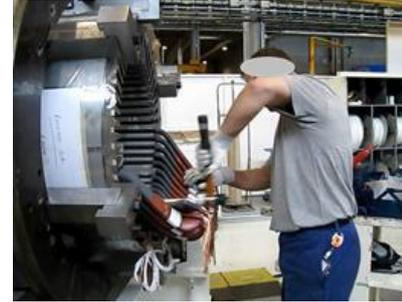
Figure 13 : opérateur procédant au calage d'encoches dans un stator à l'aide d'un maillet.
