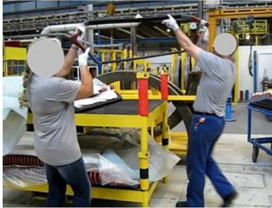
Figure 12 : opérateurs soulevant une bobine d'un rack pour l'insérer dans un rotor.
