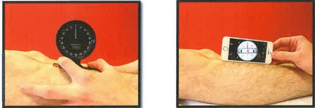
Figures 5 et 6. Mise à zéro de l'inclinomètre (à gauche) et du smartphone (à droite)
