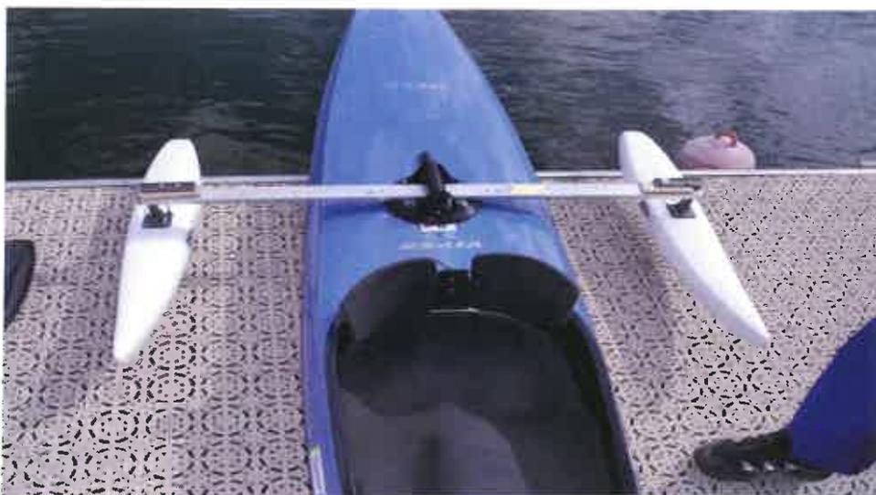
Figure 6 : Flotteurs de stabilisation
