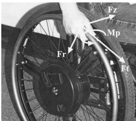
Figure 4 : Boninger *et al.* (2003). Le SMARTWheel est un dynamomètre qui permet de mesurer les moments de force sur la main courante dans les 3 dimensions. Fr représente la force radiale, elle est dirigée vers le centre de la roue. Ft, perpendiculaire à Fr, est la force tangentielle et réalise le mouvement en avant. Fz est la force axiale et elle est dirigée le long de l'axe de la roue. Mp est le moment impulsé par la main, il n'est pas dans l'axe de la roue.
