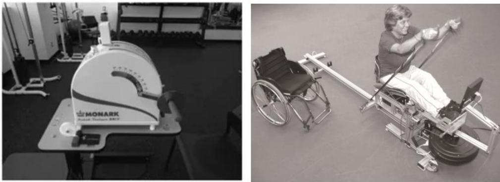
**Figure 7** : La photo de gauche représente un ergomètre à bras de Pelletier *et al.* (2014). La photo de droite représente un ergomètre assis double-pôle de Lindberg *et al.* (2012)
