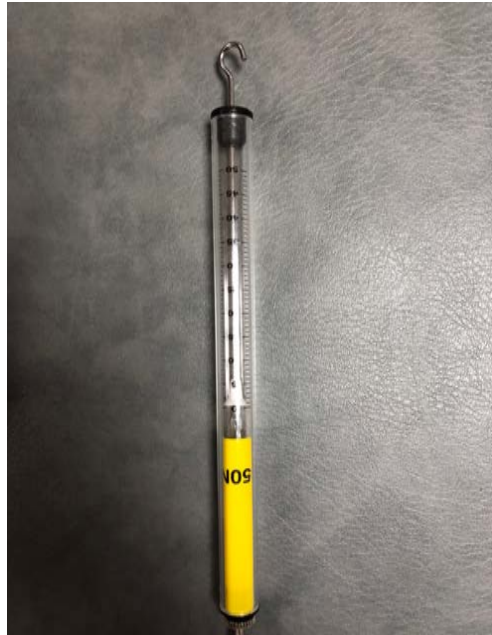
Figure 3 : Dynamomètre à ressort utilisé pour apposer la même tension sur les attelles
